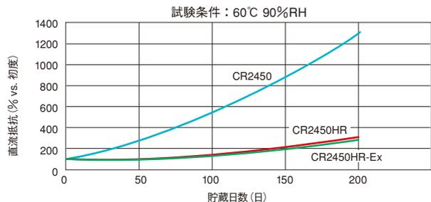
加湿雰囲気 ( $60^{\circ}\text{C}$ 90%RH) 貯蔵による内部抵抗劣化がCR2450と比べて非常に小さい
